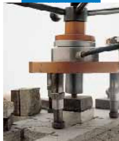
Essais d'adhérence (SATTEC)
